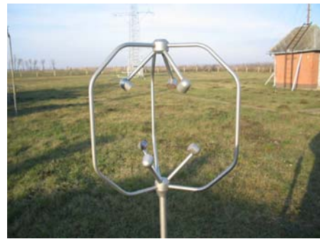
2. ábra. Metek szonikus anemometer, jól látszik az egymással szemben elhelyezkedő három hangforrás–detektor pár.
