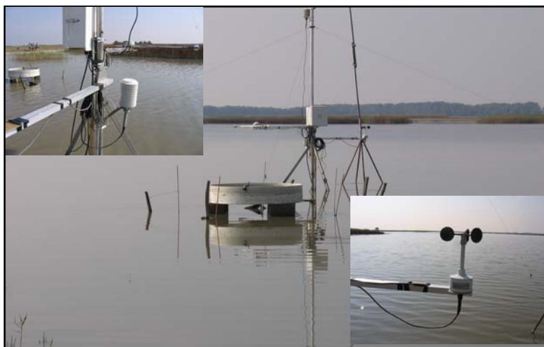
6. ábra. Mikrometeorológiai mérések Kelemen-széken. (Szélsebesség, hőmérséklet és nedvesség mérés két szinten, valamint csapadék, szélirány, globálsugárzás, sugárzásegyenleg és 2 mélységben vízhőmérséklet).
