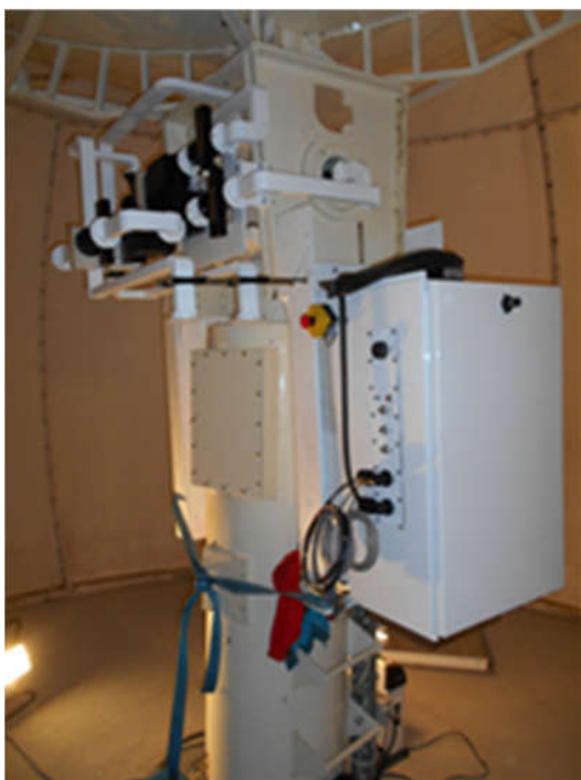
Az új csőtápvonalak és az ún. RF-box a beszerelés után
